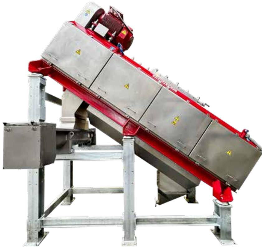
El Paddle Washer está diseñado para lavar los envases y reducir el peso de los residuos de embalaje. La máquina proporciona un plástico extremadamente limpio, aumenta el rendimiento de la fracción orgánica y ahorra significativamente en costos de eliminación.
