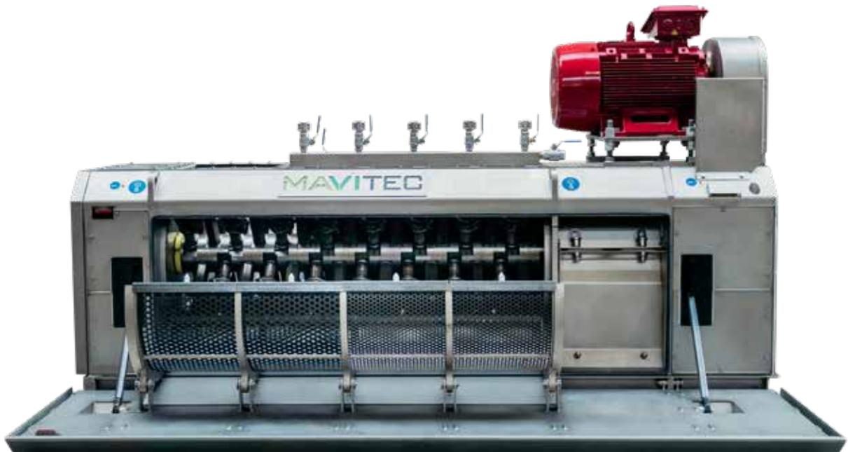
Der Paddle Depacker ist dafür ausgelegt, die Verpackung vom organischen Material zu trennen. Er erzeugt ein sauberes organisches Ergebnis, das sich besonders für Biogasanlagen eignet. Mit seinem einfachen und wartungsarmen Design hebt sich der Paddle Depacker von anderen Systemen ab.
