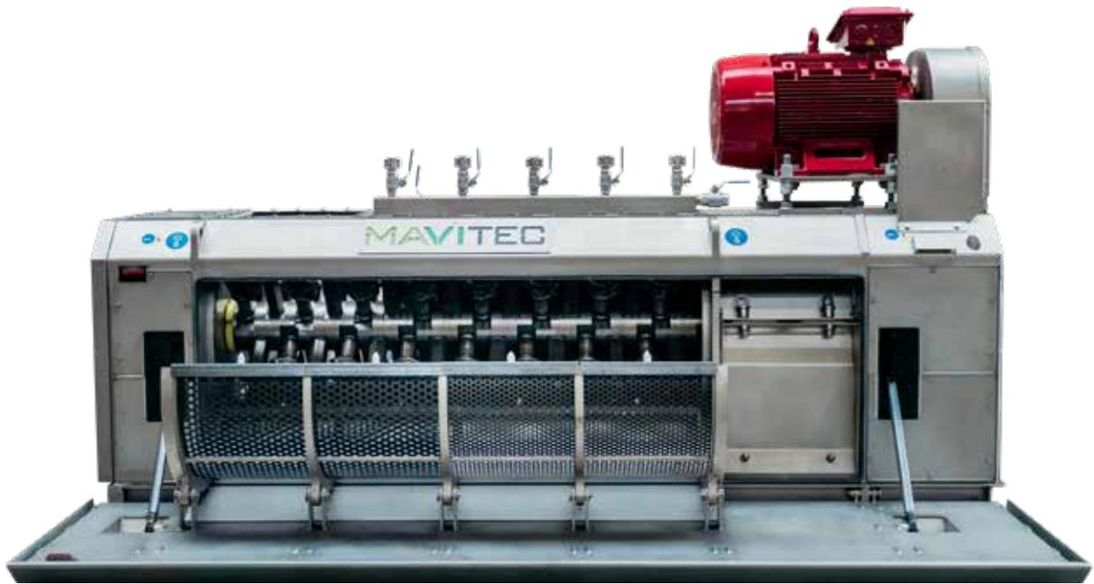
El Paddle Depacker está diseñado para separar los envases del material orgánico. Produce un resultado orgánico limpio que es extremadamente adecuado para instalaciones de biogás. Con su diseño simple y de bajo mantenimiento, el Paddle Depacker se diferencia de otros sistemas.
