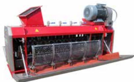
Il Paddle Depacker Roadshow: un'unità di noleggio mobile per testare il proprio materiale presso il proprio sito.
