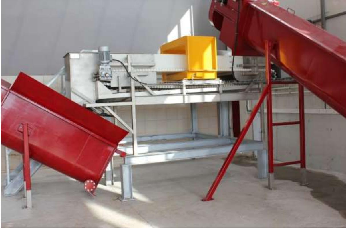
**Функционирование:** детектирование и отделение металлической стружки из сырья перед процессом обработки.
