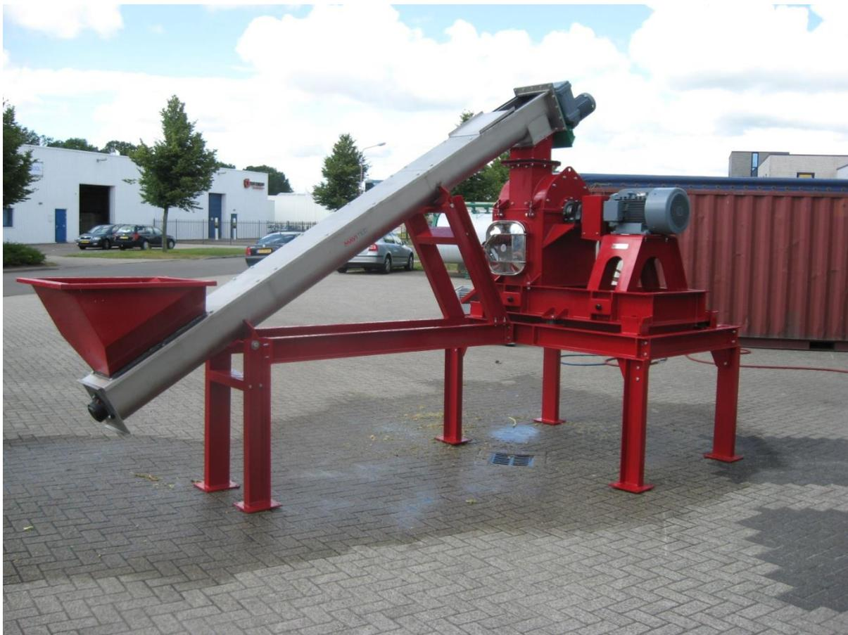
**Функция:** измельчение отходов производства, ресторанных отходов и любых других продуктов, пригодных для переработки и/или биогаз индустрии.
